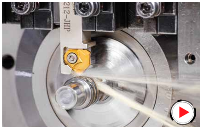
Bild 5 – QUICK-2-CUT smala, tangentiellt monterade, dubbelsidiga högprecisions-skär för av- och spårstickning.
