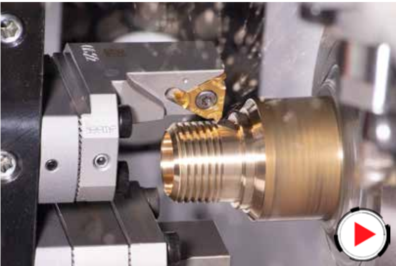
Bild 4 QUICK-SWISS modulärt system som tillhandahåller en lösning för de flesta applikationer som utförs i längdsvarvens subspindel.
